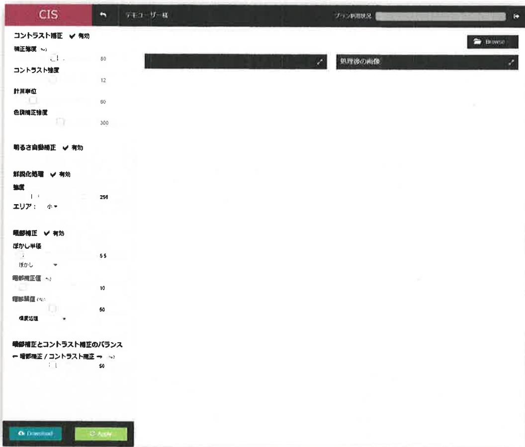
画面左側にはパラメータ調整用のチェックボックスやスライダー等があり、画面右側でアップロード画像と調整したパラメータを適用した処理後画像を比較できます。
